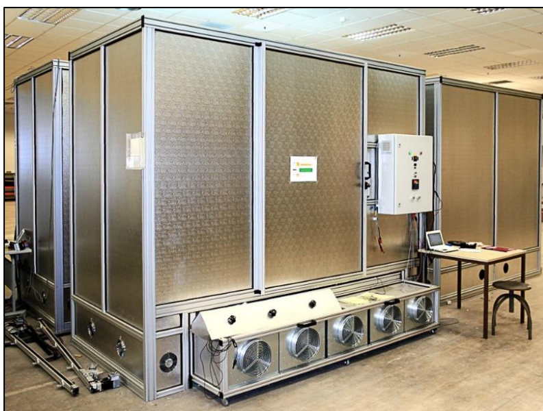
Rys. 5.7 Symulator światła słonecznego wykorzystywany do wykonywania testów wydajności modułów.
