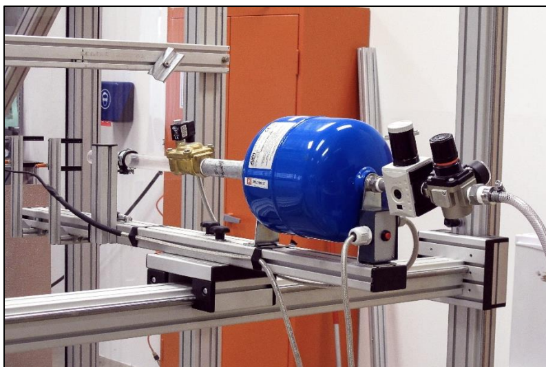
Rys. 5.6 Armatka z gradem o średnicy maks. 75mm do badania odporności na gradobicie.
