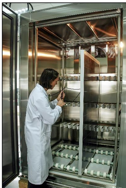
Rys. 5.9 Komora klimatyczna do badania jakości modułu.
